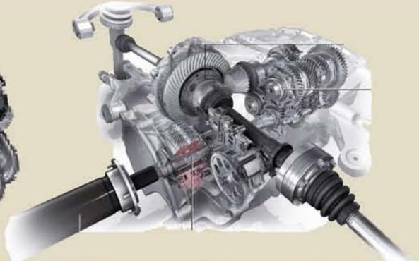
**SCHNELL** Das neu entwickelte Siebengang-Doppel-kupplungsgetriebe mit integriertem Sperrdifferenzial ist an der Hinterachse montiert (Transaxle-Bauweise)
