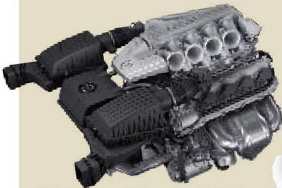
**STARK** Der 6,3-Liter-V8-Motor leistet 571 PS bei 6800 Touren und stellt ein maximales Drehmoment von 650 Newtonmetern bei 4750 U/min parat
